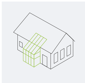
Pultová střecha – řešení zapojené do střešní konstrukce
